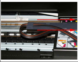
그림3-15 헤드몽치를 오른쪽 끝으로 보낸 뒤에 튜브를 꼬이지 않게 화살표 방향으로 살짝 당겨주세요.
