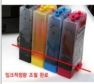
그림 3-22 서너차례 반복해주시면 해당사진처럼 작은 방의 잉크가 10%정도만 남게 됩니다. 이후에는 압력에 의해 자동 조절 되므로 한번씩 확인만 해주시면 됩니다.
