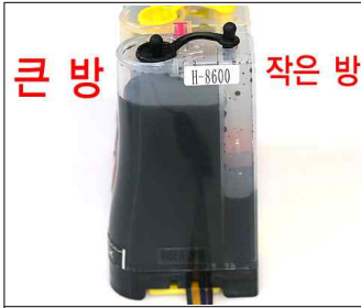
그림3-19 사진에서 보는 것처럼 외부잉크탱크의 큰 방과 작은 방의 검정색 잉크량이 차이가 나는 것이 보입니다. 작은 방의 잉크량은 4색 모두 항상 10%이하 정도로 유지되어야 합니다.
