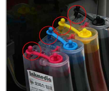
그림 3-24 잉크탱크의 작은 마개를 모두 열어줍니다. 큰 마개는 평소에 닫혀있어야 합니다.
