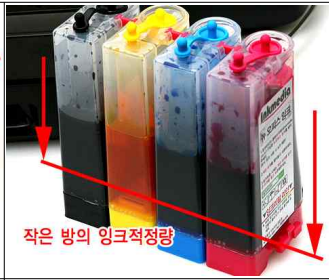
그림 3-20 현재 작은 방 내부에 잉크가 50%이상 가득차 있습니다. 이곳을 10%미만으로 비워줍니다.
