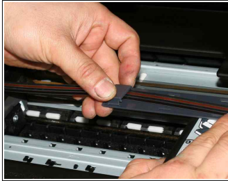
그림 3-10 끝까지 밀어준 다음 튜브가 꼬이지 않게 일자가이드에 걸어줍니다
