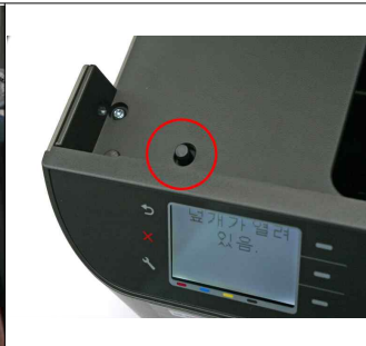
그림3-26 빨간색 동그라미부분이 뚜껑을 감지하는 센서입니다.
