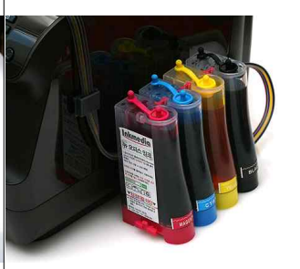
그림 3-23 사진처럼 잉크탱크를 측면에 놔주시고, 프린터와 같은 높이에 위치하도록 해주세요. 프린터보다 높거나 낮을 경우 잉크공급에 지장이 생길 수 있습니다.
