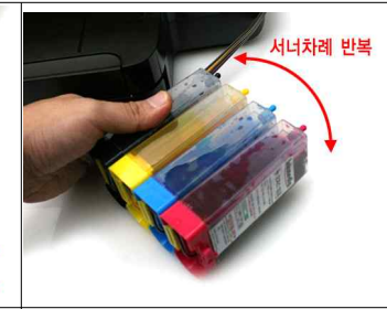
그림 3-21 사진처럼 잉크통을 기울였다가 세웠다가를 반복해줍니다. 그러면 서로 아래쪽으로 이어진 통로를 통해 잉크와 공기가 이동합니다.
