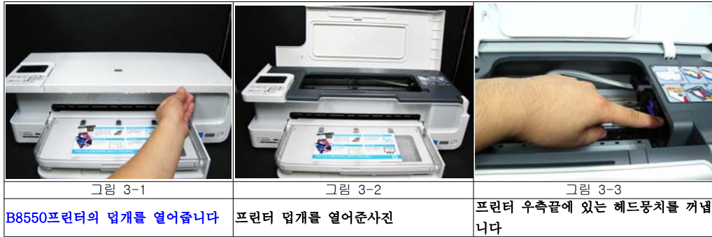
그림 3-1 B8550프린터의 덮개를 열어줍니다 그림 3-2 프린터 덮개를 열어준사진 그림 3-3 프린터 우측끝에 있는 헤드몽치를 꺼냅니다 그림 3-4 헤드몽치를 프린터 가운데 가져옵니다 그림 3-5 헤드몽치의 손잡이를 올려줍니다. 그림 3-6
