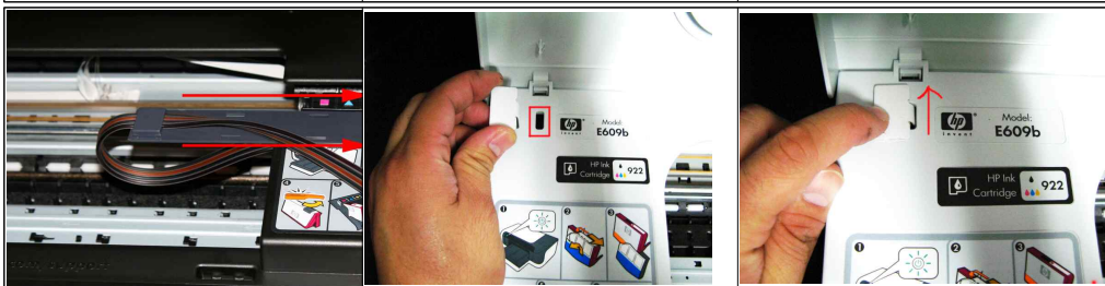
그림 3-16 튜브를 꼬이지 않게 화살표방향으로 가지런히 정리해줍니다. 그림 3-17 빨간색박스친 부분에 센서가이드를 끼웁니다. 그림 3-18 살짝 눌러주고 화살표처럼 위로 올려줍니다.(위로 올려주어야 인식됨)
