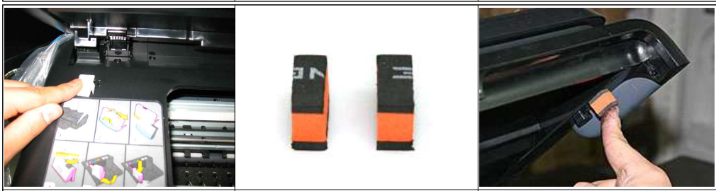
그림 3-19 살짝 눌러줍니다. 그림 3-20 무한공급기 선 보호용 덮개쿠션입니다. 그림 3-21 반대쪽도 같은 방법으로 부착합니다. 2개 다 부착 후 프린터 덮개를 닫아주세요.
