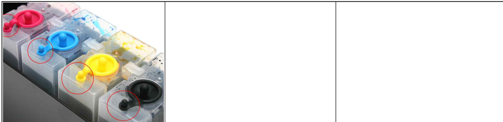
그림 3-22 에어홀 마개작은 구멍의 고무 캡을 4개 모두 열어주세요. 잉크 충전 시에는 반드시 작은 마개를 닫아주세요.
