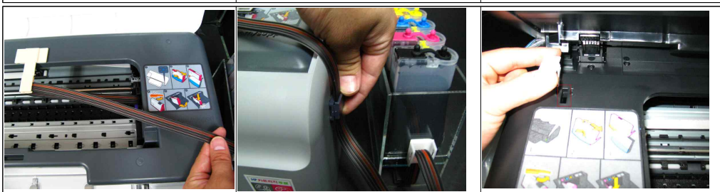
그림 3-16 헤드몽치를 오른쪽끝으로 보낸뒤에 튜브를 꼬이지 않게 살짝잡습니다 그림 3-17 튜브고정부품의 양면테이프뒷면을 제거합니다. 그림 3-18 빨간색 박스 친 부분에 센서가이드를 끼웁니다.
