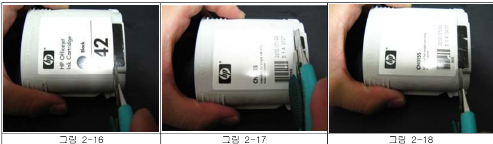
그림 2-16 그림 2-17 그림 2-18 카타칼로 아래까지 잘라준사진 카트리지 뒷부분도 동일하게 카타칼로 살짝 그어줍니다.
