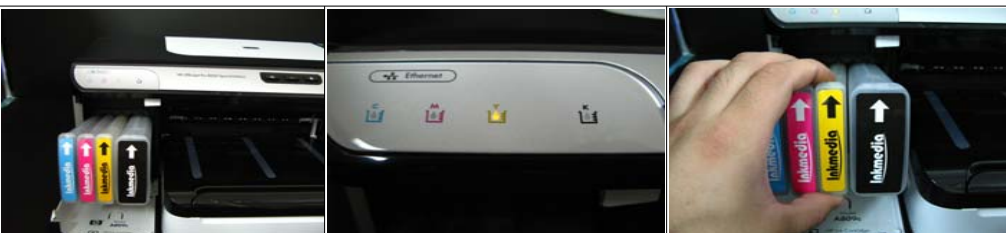
그림 4-1 잉크미디어 무선 이지카트리지를 사용하는중에 인쇄가 안됩니다. 그림 4-2 프린터에서 노란색 잉크없음에 LED가 깜빡입니다. 그림 4-3 무선 이지카트리지 노란색을 빼내서 확인합니다.
