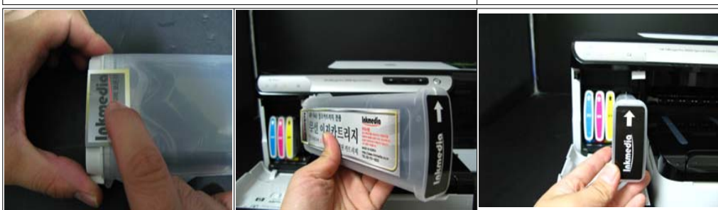
그림 2-31 그림 2-32 그림 2-33 카트리지 뒷부분도 동일하게 스티커를 부착합니다. 칩가이드와 합체 완료된 무선 이지카트리지 블랙 제품입니다. 카트리지의 화살표 부분을 위로오게하여 프린터에 설치합니다
