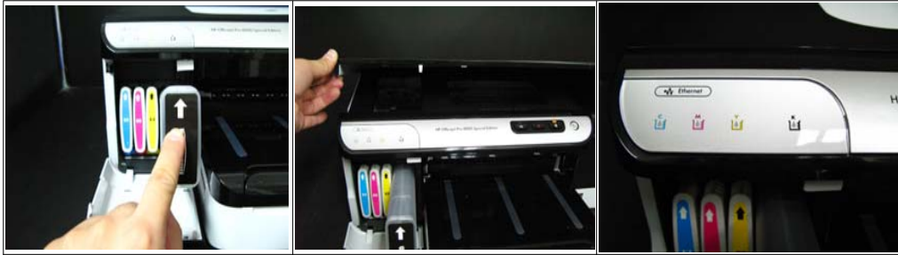
그림 2-34 그림 2-35 그림 2-36 손가락으로 살짝눌러 프린터에 장착합니다. 프린터 뚜껑을 열었다가 닫아줍니다. 프린터 잉크잔량 LED에 블랙잉크가 없음이 표시된 것이 없어졌습니다.
