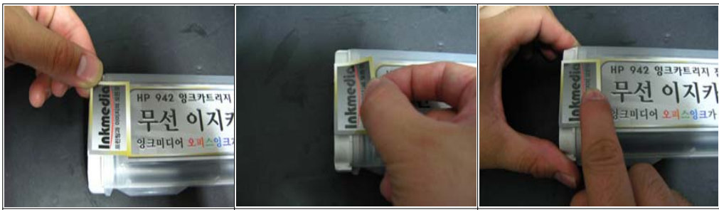
그림 2-28 그림 2-29 그림 2-30 칩가이드 끝선에 맞추며 스티커를 부착합니다. 손으로 눌러주며 잘부착합니다.
