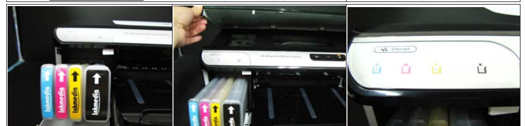
그림 4-13 노란색 무선이지카트리지를 프린터에 장착합니다. 그림 4-14 프린터 뚜껑을 열었다가 닫아줍니다. 그림 4-15 프린터에서 노란색 잉크없음에 LED가 깜빡임이 없어집니다.
