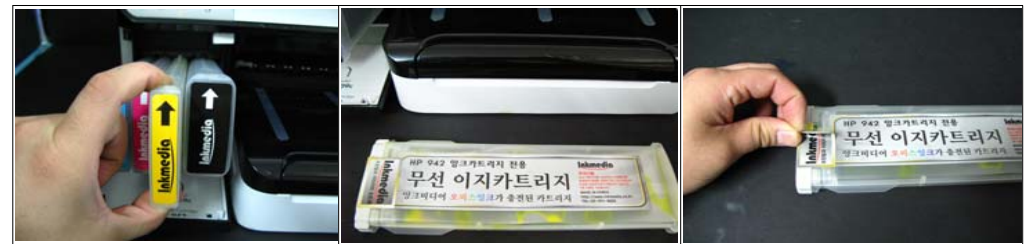
그림 4-4 무선 이지카트리지 노란색을 빼내서 확인합니다. 그림 4-5 노란색 무선 이지카트리지를 프린터에서 제거한 사진입니다. 그림 4-6 칩가이드 고정스티커를 떼어냅니다.
