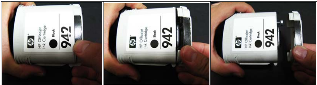
그림 2-19 그림 2-20 그림 2-21 카타칼로 그어준 카트리지 하단부를 분리시켜줍니다.->카트리지 하단부를 아래부터 칩가이드로 부릅니다.
