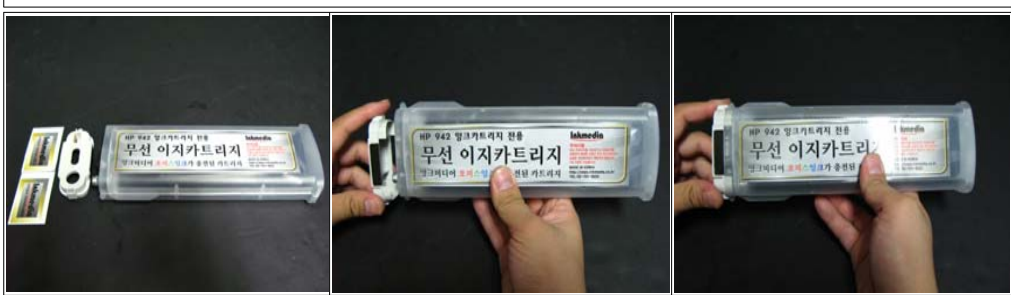
그림 2-22 그림 2-23 그림 2-24 칩가이드 고정 스티커 2장, 칩가이드, 무선 이지카트리지 블랙색상입니다. 칩가이드와 무선 이지카트리지 블랙을 결합합니다.(방향에 주의합니다.)
