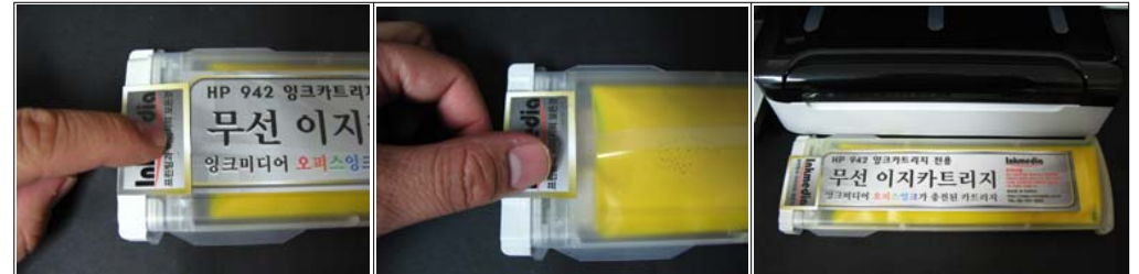
그림 4-10 노란색 칩가이드를 새로운 노란색 무선이지카트리지에 결합후 칩가이드 고정 스티커를 붙여줍니다.(그림 2-19부터 참조) 그림 4-11 칩가이드와 결합완료된 새로운 노란색 무선이지카트리지입니다. 그림 4-12 칩가이드와 결합완료된 새로운 노란색 무선이지카트리지입니다.
