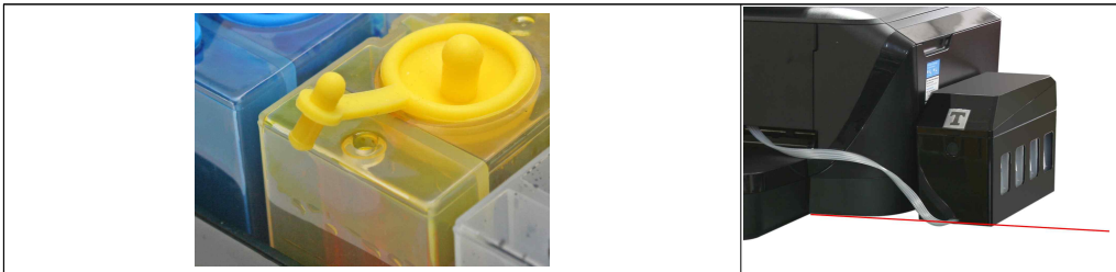
신형 그림 1-16 에어홀 마개작은 구멍의 고무 캡을 4개 모두 열어주세요. 4가지 색상의 고무캡을 모두 열어 줍니다. 프린터 사용 시 공기가 주입될 구멍입니다. 추후 당사 a/s 보내실 때는 위 마개 4색을 다 막아야 합니다. 신형 그림 1-17 신형 그림 1-18 프린터의 바닥높이와 무한키트 바닥면의 높이를 항상 동일하게 놓아줍니다(높거나 낮을 경우 잉크가 세고 정상출력안되고 헤드손상될수 있음)
